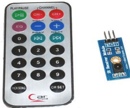
Fig. 12 - Controle Remoto e seu módulo receptor
