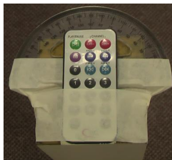
Fig. 34 - Procedimento para medir a sensibilidade do receptor de IR
