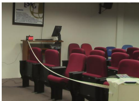
Fig. 34 - Procedimento para medir a sensibilidade do receptor de IR
