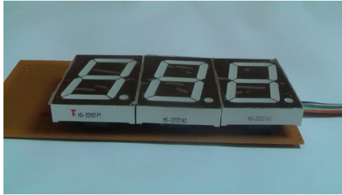
Fig. 30 - Displays interligados para teste em placa provisória
